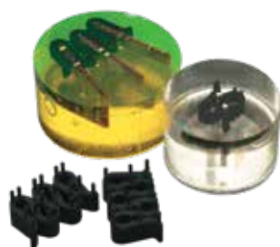
Le MultiClips peut accepter jusqu'à 5 petits échantillons minces.
