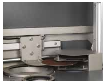
Etape 4: Le consommable MD suivant est pris au magasin mobile de stockage et amené au MD-Disc.
