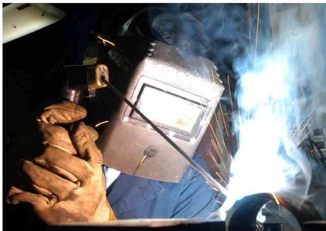
*Soudage à l'arc avec électrode enrobée*
