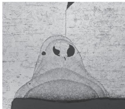
*Porosités dans une soudure en acier inoxydable austénitique. Fond clair, 100x.*
