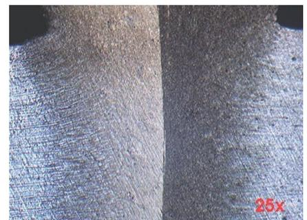
Fig. 3: Interface de fusion sur un alliage d'acier faiblement allié soudé par friction linéaire sous pression, montrant une zone affectée thermiquement et une déformation plastique associée. Fond clair, 25x.
