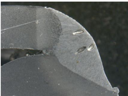
**Analyse des défauts** / identification et caractérisation des défauts de soudures.
