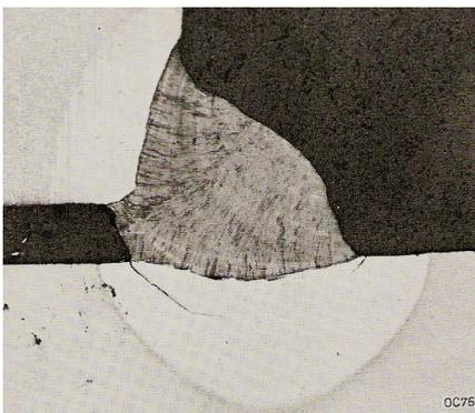
*Zone affectée thermiquement au-dessous du cordon de soudure dans une acier faiblement allié. Fond clair, 5x.*
