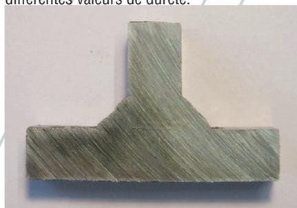
*Dommage thermique sur une soudure en acier.*
