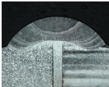
Section polie mécaniquement et attaquée électrolytiquement dans une soudure par gaz inerte de tungstène par micropulsion dans de l'alliage Inconel 625. Après attaque à l'acide oxalique 10%; 10 Volts pendant 10 s. Fond clair, 2,5x.
