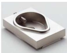
**Porte-échantillons CATFF, type goutte d'eau avec une ouverture**
