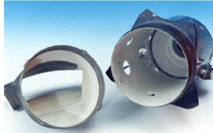
Brennkammer mit APS-Wärmedämmschicht, Haftschicht NiCrAlY, Deckschicht  $ZrO_2 + Y_2O_3$
