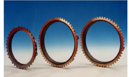
Synchronringe aus Messing mit Molybdän-Spritzschicht, aufgebracht mittels Flammgespritzen
