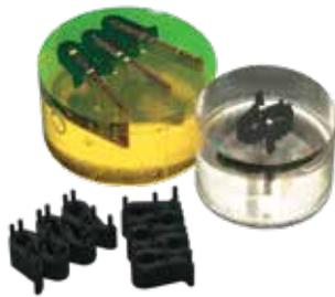
MultiClips können bis zu fünf kleine, dünne Proben aufnehmen.
