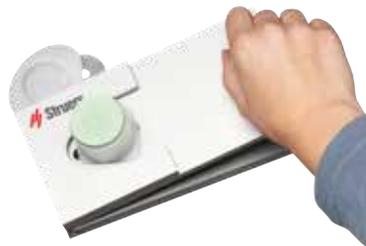
Mit Wupty lassen sich Einbettungen leichter aus FixiForm herausdrücken.
