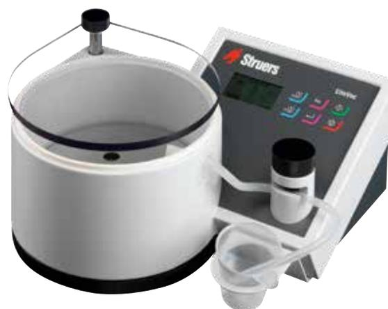
CitoVac für die einfache Imprägnierung empfindlicher Werkstoffe
