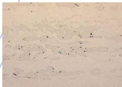
Abb. 2: Zerbrochene Primärkarbide
