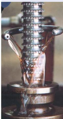
Schneidwerkzeug aus Schnellarbeitsstahl
