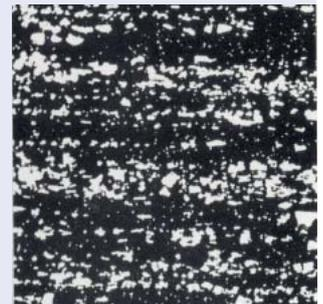
Abb.11: Karbidverteilung bei konventionell hergestelltem Stahl
