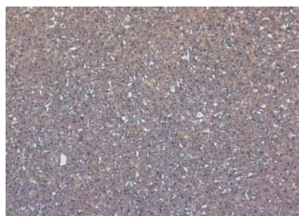
Abb. 4: Kaltarbeitsstahl geätzt mit 10% Nital, Primärkarbide werden weiß hervorgehoben
