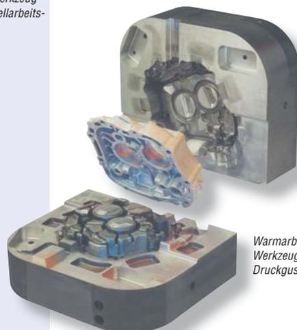
Warmarbeitsstahl Werkzeug für Druckguss
