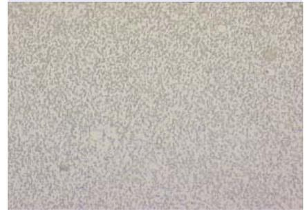
Abb.10: Kunststoffformenstahl nach dem Glühen zeigt fein verteilte Karbide
