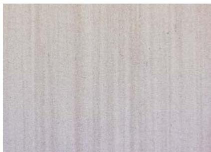
Fig. 8: Warmarbeitsstahl mit Entmischungen
