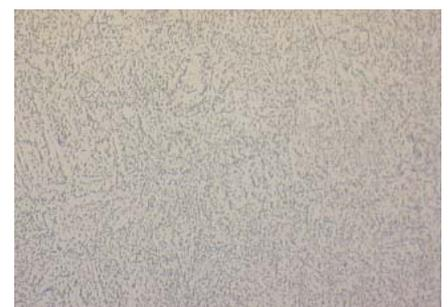
Abb. 5: Warmarbeitsstahl geätzt mit Pikrinsäure und Nital, Gefüge besteht aus globularem Perlit
