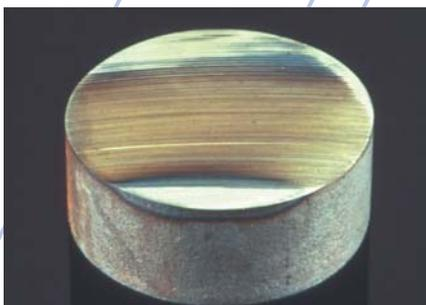
Abb. 1: Thermische Schäden erzeugt durch falsche Trennbedingungen
