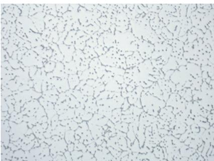
Abb. 3: Al-Legierung 2024, Gusszustand, eutektisches Korngrenzengerüst, ungeätzt, 200x.
