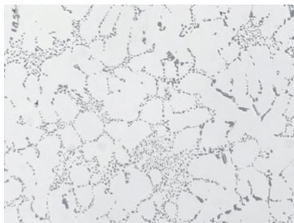
Abb. 10: Wie Gefüge Abb. 9, jedoch feingepoliert mit OP-U Suspension, Grundgefüge ist gut auspoliert und Eutektikum ist deutlich kontrastreicher, 200x.
