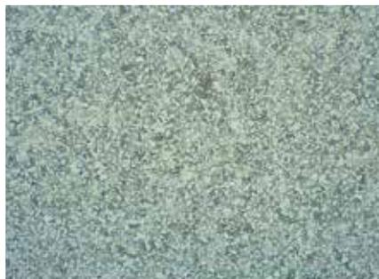
**RepliSet** ist ein komplettes Abdrucksystem, das die Mikrostruktur einer Oberfläche in einen höchst genauen und haltbaren Abdruck umsetzt. Das Ergebnis ist eine dreidimensionale Kopie der Oberfläche zur Untersuchung im Auflichtmikroskop und/oder für genaue Messungen.
