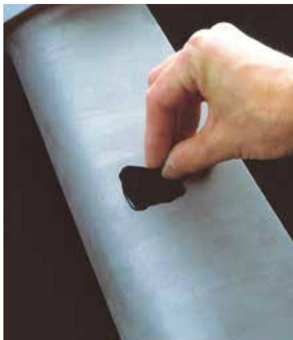
Der ausgehärtete Abdruck wird von der Probe abgezogen
