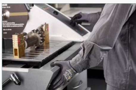
Funzionamento di sicurezza a due mani a coperchio aperto
