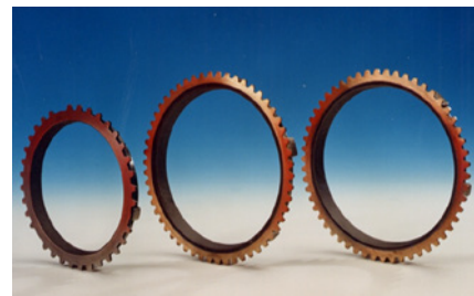
耐摩耗性のためにモリブデンをフレーム溶射された真鍮シンクロナイジングリング
