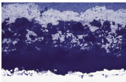
図9:熱間加圧埋込みを原因としたセラミック溶射皮膜に対する損傷 200x
