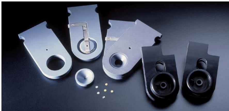
Um porta-amostras para amostras de 3 mm para afinamento final, com abertura de 10 mm de diâmetro para pré-afinamento ou puncionamento eletrolítico e um conjunto de suportes de jato. O conector de platina e a fixação deslizante da amostra podem ser vistos.
