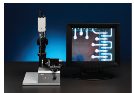
Fig. 11: Vídeo Target-Z para posicionamiento y medición de objetivos visibles
