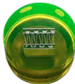
EpoDye es un tinte fluorescente que se mezcla con la resina para facilitar la identificación de poros y fracturas al examinar la muestra bajo una luz fluorescente.
