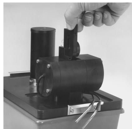
3. 将两个微型插头插入喷射座的相应插孔内。
