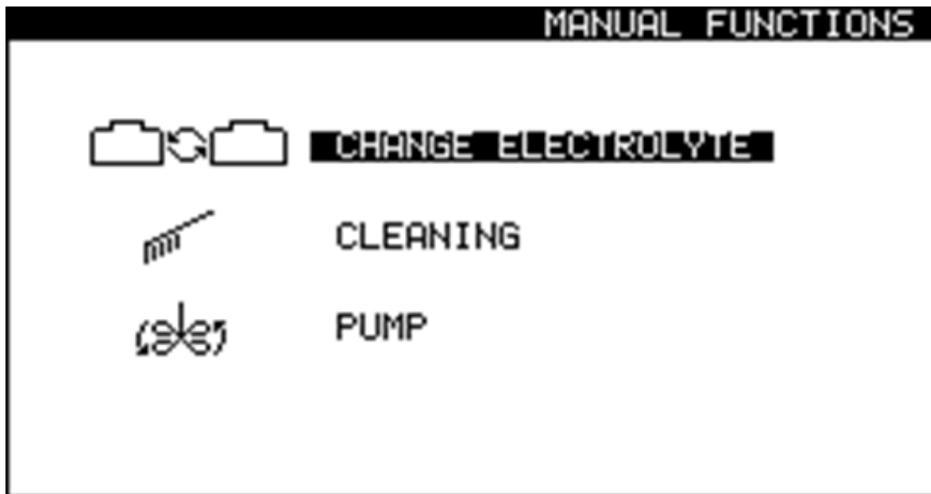
清空电解液容器后，必须通过抛光格泵入水来清洁抛光装置。
