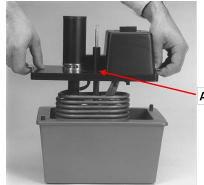
3. 将抛光装置附带的一根管连接到冷却旋管和水源。
