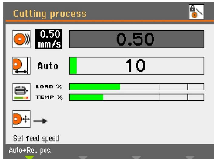
Lorsque le courant du moteur descend en-dessous de la valeur minimale spécifiée, la barre repasse au gris et le tronçonnage s'arrête.
