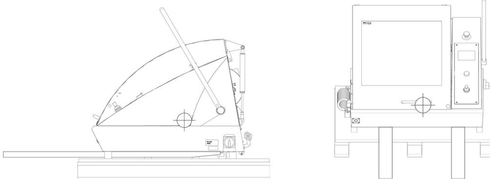
5. Soulever la machine et la déposer sur le meuble.
