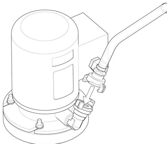
2. Raccorder le tuyau d'arrivée d'eau à la pompe de refroidissement en utilisant l'accouplement rapide.
