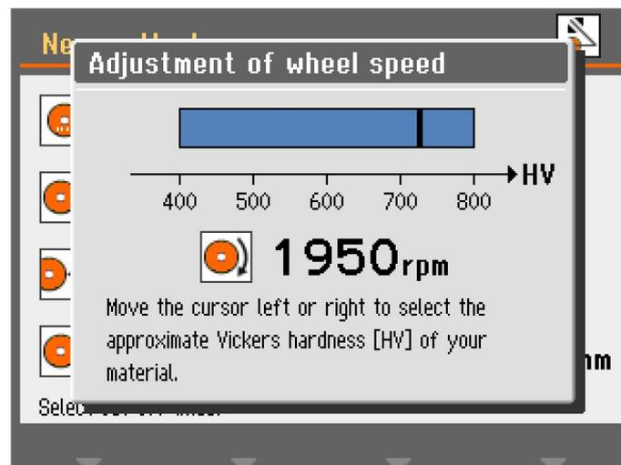
3. Sélectionner la dureté Vickers du matériau à tronçonner. La vitesse en t/m de la meule de tronçonnage est modifiée en conséquence.
