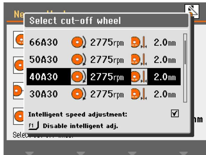
2. Sélectionner une meule de tronçonnage pour ajuster les t/m.
