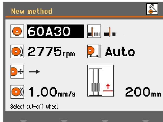
1. Sélectionner le paramètre de la **meule de tronçonnage**.
