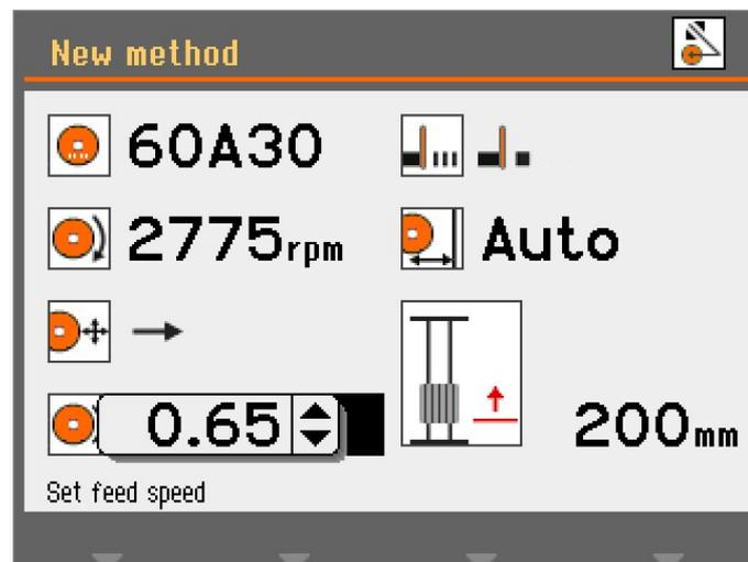
2. Utiliser le bouton pour ajuster et accepter les paramètres.
