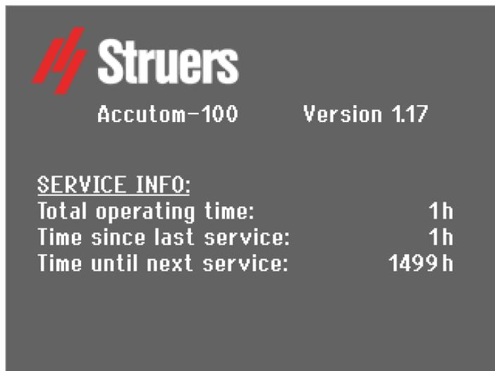
Lorsque la machine est mise sous tension, l'écran affiche la configuration et la version du logiciel installé.
