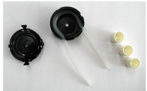
5. Retirer le tube en Novoprène.
