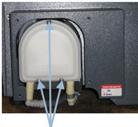
2. Retirer les trois vis sur le couvercle de la pompe de refroidissement.
