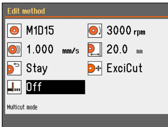
Lorsqu'une table X automatique est connectée, le **Multicut mode** (Mode MultiCut) s'affiche sur la page Méthode de tronçonnage.
