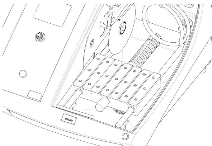
La machine est équipée d'une table de tronçonnage mobile.
