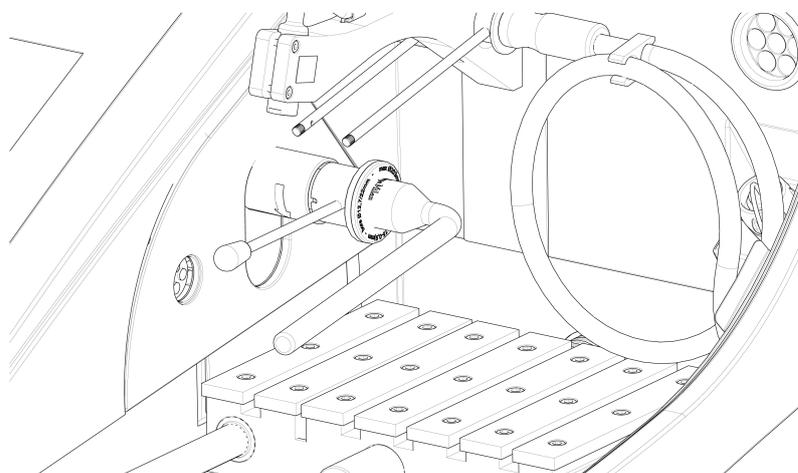
3. Insérer le goujon dans l'orifice prévu sur la broche de la meule de tronçonnage.
