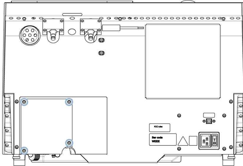
1. Retirer les quatre vis sur la plaque de protection au dos de la machine.
