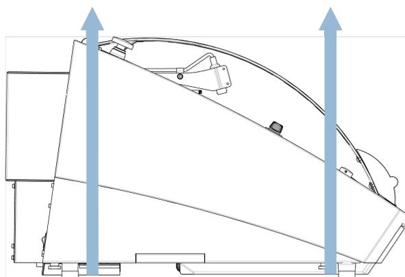
2. Positionner les sangles sous la machine de façon à ce qu'elles soient situées sur le côté intérieur des pieds.
