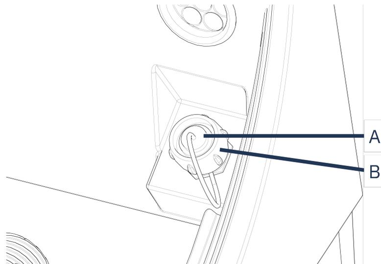
**A** Douille**B** Bague de fixation
