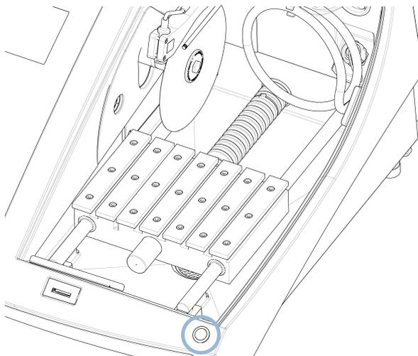
2. Presser le bouton de fonctionnement continu lors de l'action sur le joystick.
