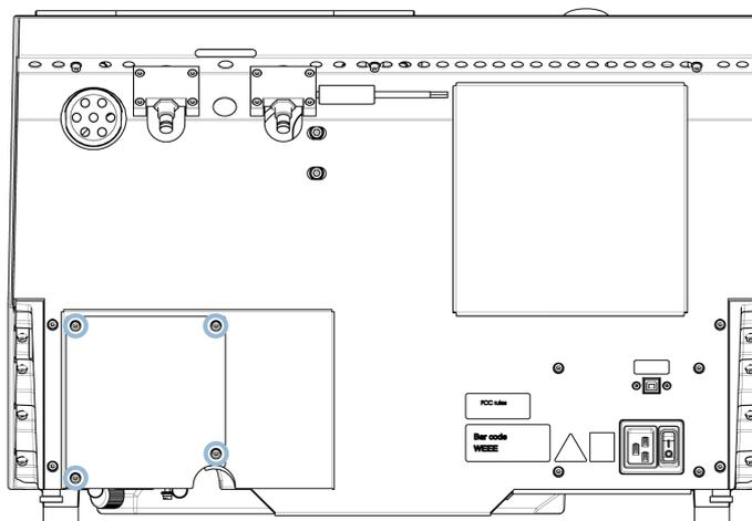
1. Entfernen Sie die vier Schrauben der Abdeckung auf der Rückseite der Maschine.
