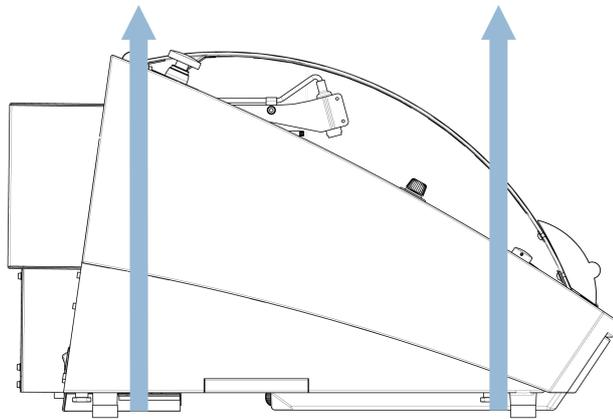
2. Platzieren Sie die Gurte so unter dem Gerät, dass sie an der Innenseite der FüÙe zu liegen kommen.
