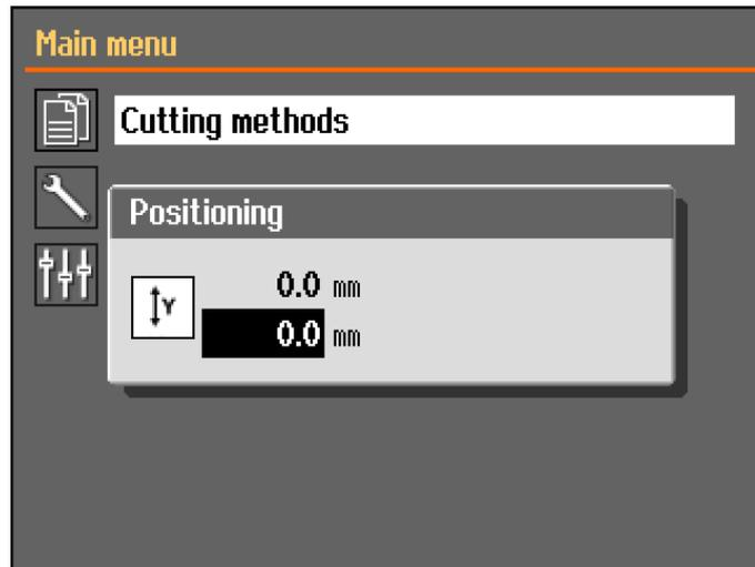
Das **Positioning** (Positionierung) Menü wird angezeigt, wenn Sie Nach oben oder Nach unten drücken.
