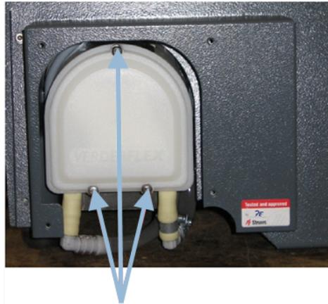
2. Entfernen Sie die drei Schrauben vom Deckel der Kühlmittelpumpe.
