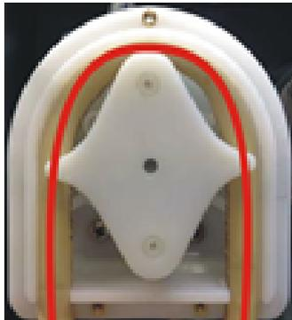
**Der Pumpenschlauch ist zu locker**
