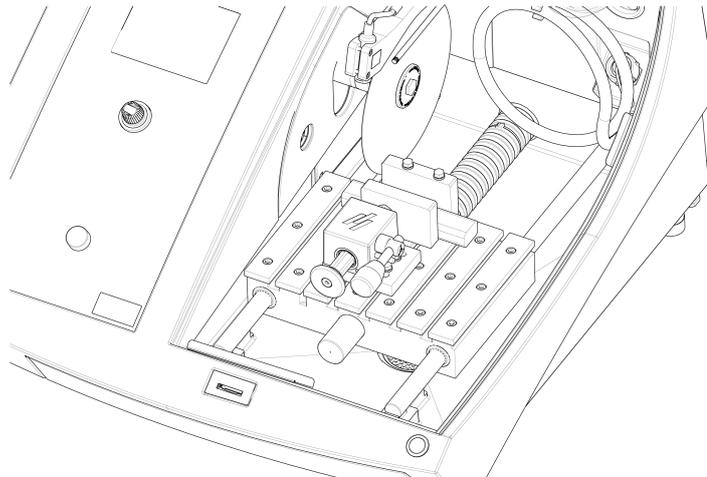
1. Positionieren Sie den hinteren Anschlag und das Spannwerkzeug wie gezeigt.
