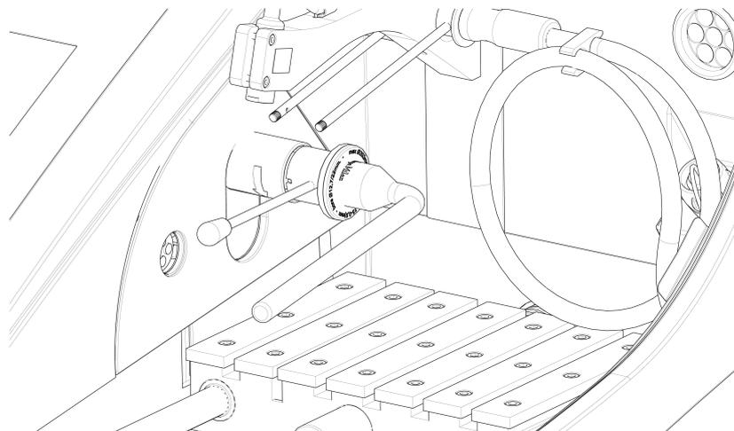
3. Führen Sie den Arretierungsbolzen in die Bohrung auf der Trennscheibenachse ein.
