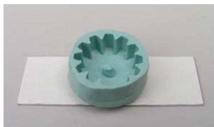
*RepliFix Abdruck eines Zahnrads auf Objekträger*
