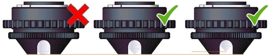
*Regolazione della punta del cono rispetto al penetratore. La punta del penetratore non deve sporgere.*
