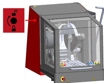
9. 安全カバーを開き、輸送用ブラケットを固定している留め具を外します。30 mm (1.18") のレンチと13 mm (0.51") のレンチを使用します。
