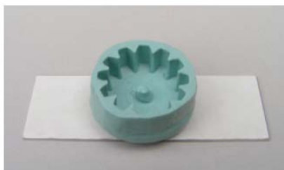
バックング・スライドにマウントした歯車のレプリフィックスレプリカ
