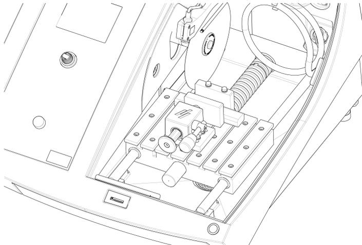
1. Coloque el tope trasero y el dispositivo de sujeción como se muestra.
