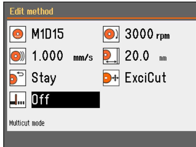
Cuando se conecta una mesa X automática, **Multicut mode** (Modo Multicorte) se muestra en la pantalla del método de corte.
