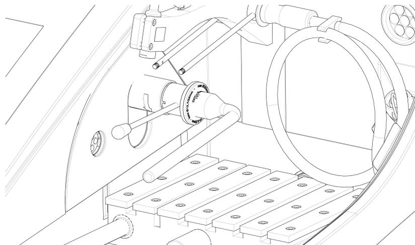
3. Inserte la palanca de fijación en el agujero del eje del disco de corte.
