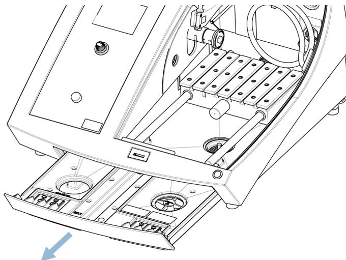
1. Deslice suavemente hacia afuera el tanque de refrigerante.
