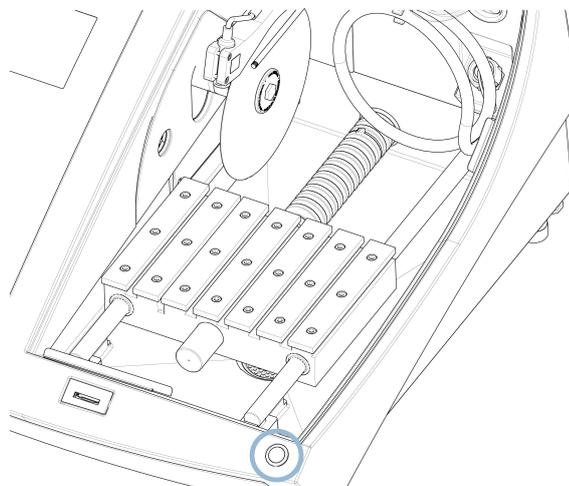
2. Presione el botón de accionamiento mantenido mientras funciona el joystick.
