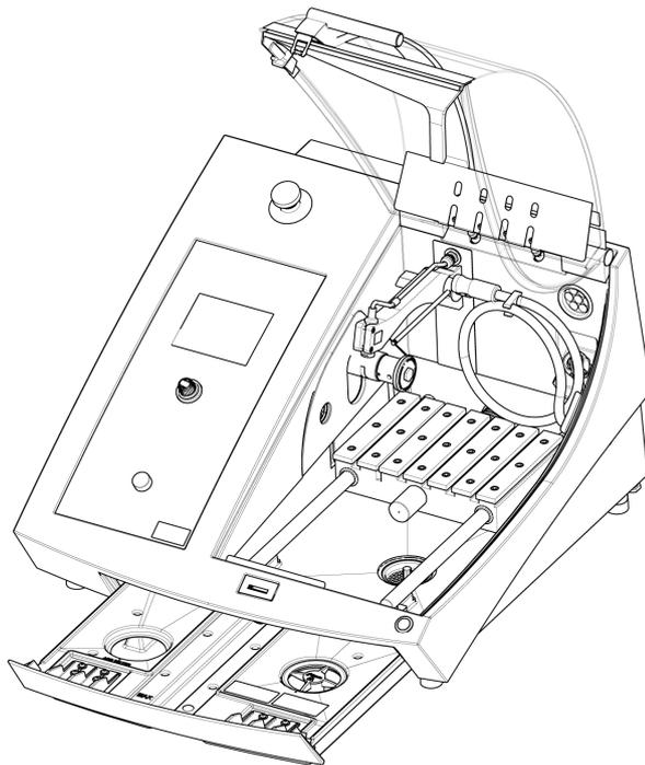
1. Asegúrese de que el tanque de refrigerante esté en posición debajo de la cámara.
