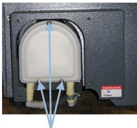
2. Retire los tres tornillos de la cubierta de la bomba de refrigeración.
