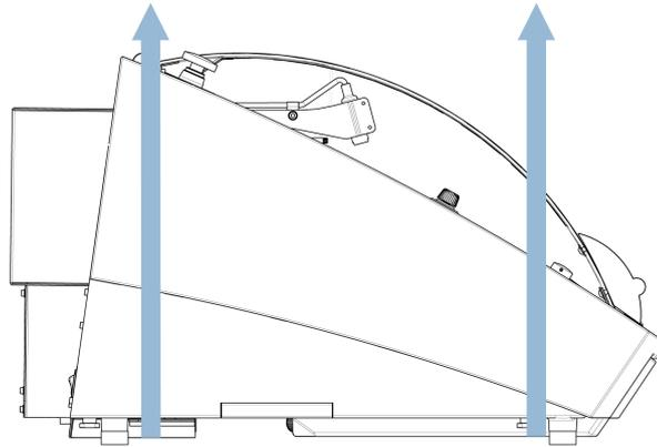
2. Coloque las correas por debajo de la máquina de modo que queden en el interior de los pies.
