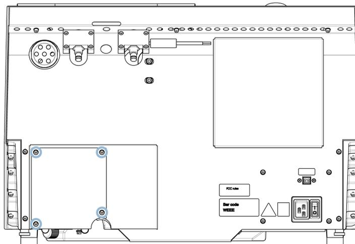
1. Retire los cuatro tornillos de la placa de protección que se encuentra en la parte trasera de la máquina.
