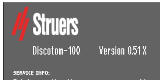
Después de 1000 horas de funcionamiento (o un número determinado de meses), se mostrará un mensaje emergente para recordarle al usuario que debería programarse una comprobación de servicio.
