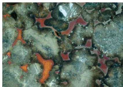
Acier en poudre métallurgique avec infiltration de cuivre
