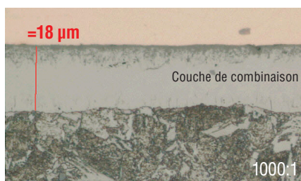
Fig. 3: Détails de la composition d'une couche nitrurée
