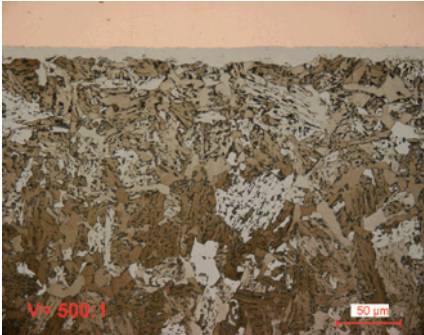
Abb. 11: Legierter Stahl, (16MnCr5N), plasma nitrocarburiert, 570°C/ 6 Std.
